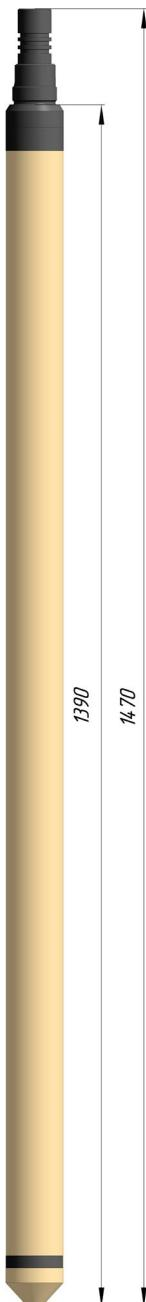
МОДУЛЬ РЕЗИСТИВИМЕТРА ИНДУКЦИОННЫЙ МРИ-28/38/42/45
